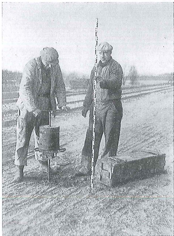
1. Boring med belastet Spidsbor
